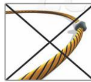
胶水固定 (易损伤线缆)
